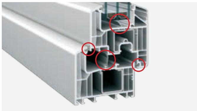
**Dichtungen** / Drei umlaufende Dichtungsebenen und eine zusätzliche Dichtung im Glasfalz sorgen für hervorragende Dämmwerte. Für beste Funktionalität und lange Lebensdauer werden die umlaufenden Dichtungen aus hochwertigem TPE gefertigt.
