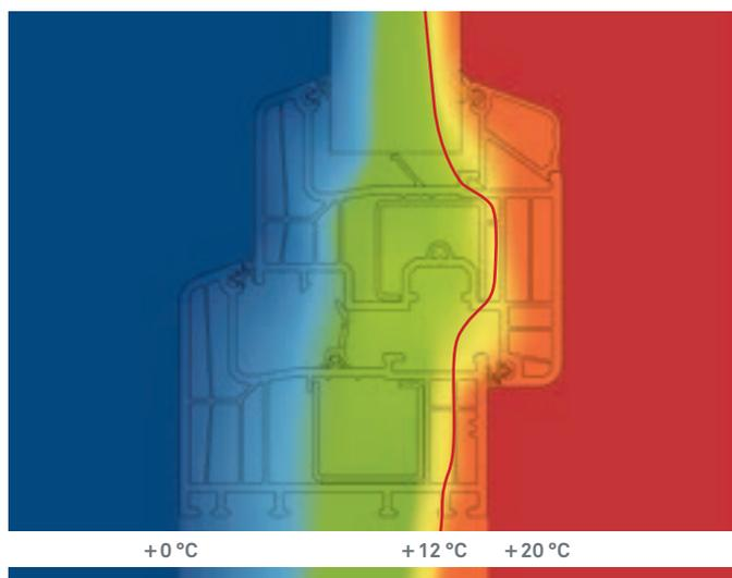
Der Isothermenverlauf zeigt die hervorragende Dämmung: Sie verhindert durch die innere, warme Oberfläche die Entstehung von Kondenswasser.
